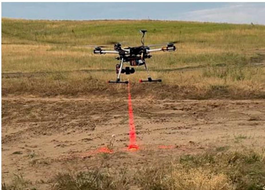
**Рисунок 2.** Проведение работ по лазерному облучению растений на стадии вегетации с применением БПЛА.
