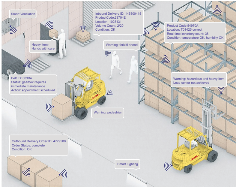
Рис. 9. Датчики и сенсоры IoT на современном складе
